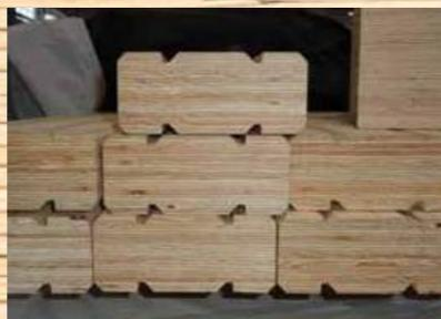
Пример фасонного фрезерования бруса
